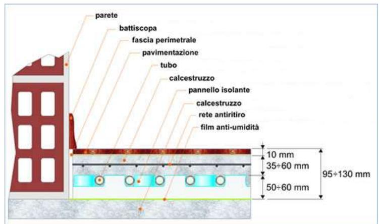
Il **solaio tra locali interrati** (spazio di manovra, box, cantine ecc.) e **unità riscaldate al piano terra** sarà così realizzata:
